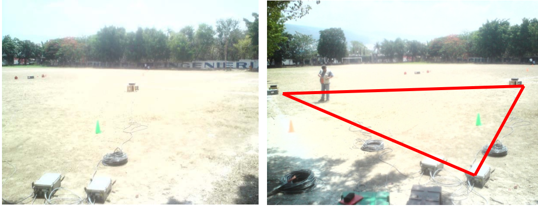
Figura 82. Fotografías que muestran el arreglo SPAC en el campo de futbol de la facultad de Ingeniería de la UNACH.
