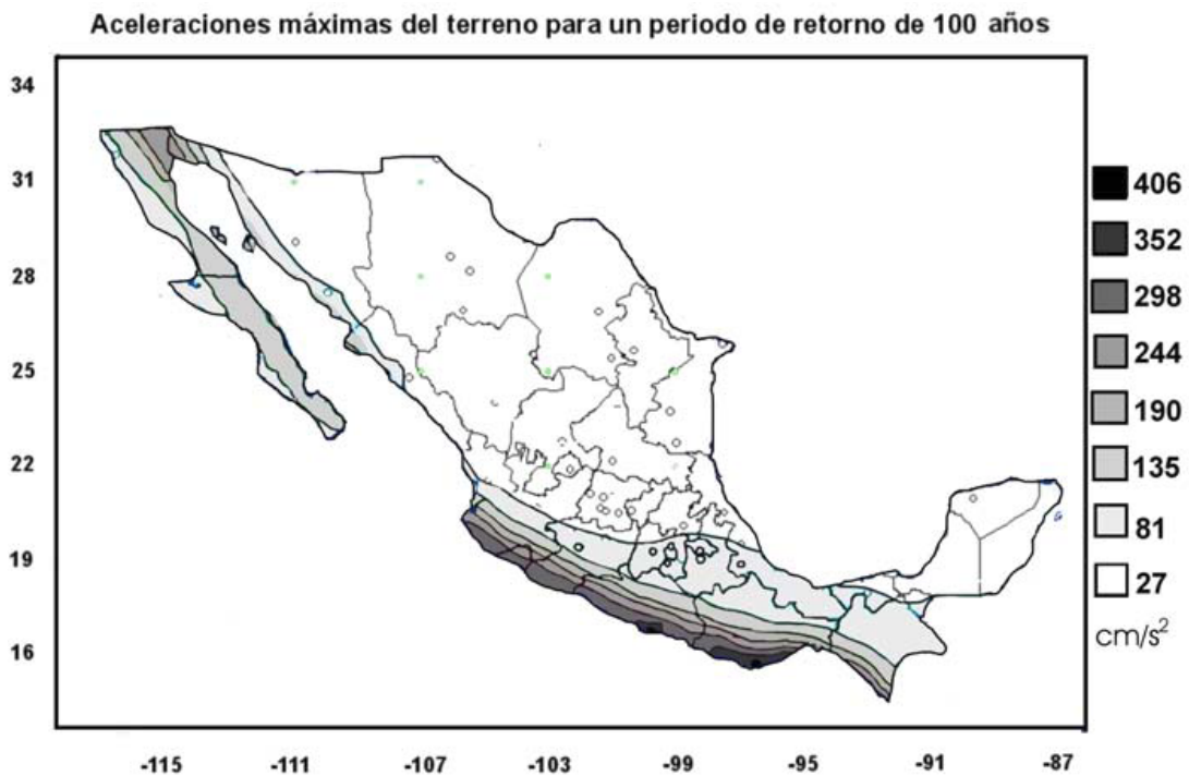
Figura 106. Mapa de valores de aceleración máxima asociados a un periodo de retorno de 100 años (81 gals), PSM, 2004.
